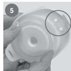
5 Sett Hetteinnlegget på Hetten . Pass på at de to tappene går inn i hullene. Klem delene godt sammen.
